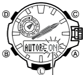
Индикатор включенного (On) или выключенного (Off) автоматического приема сигнала радиокалибровки
